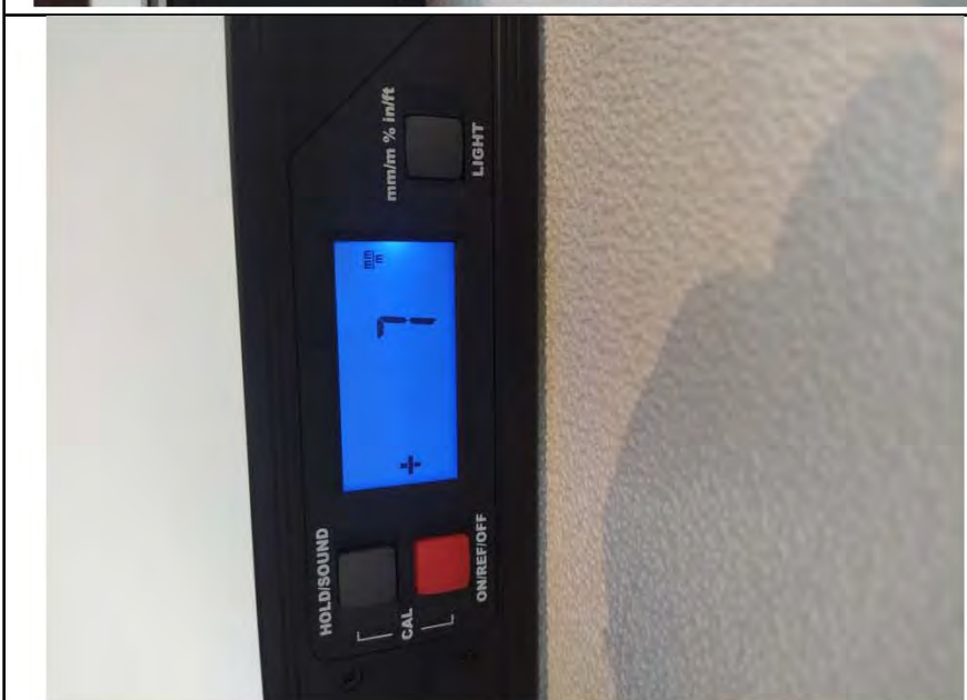
Фото №9. Измерение уровня стен в кухне.
