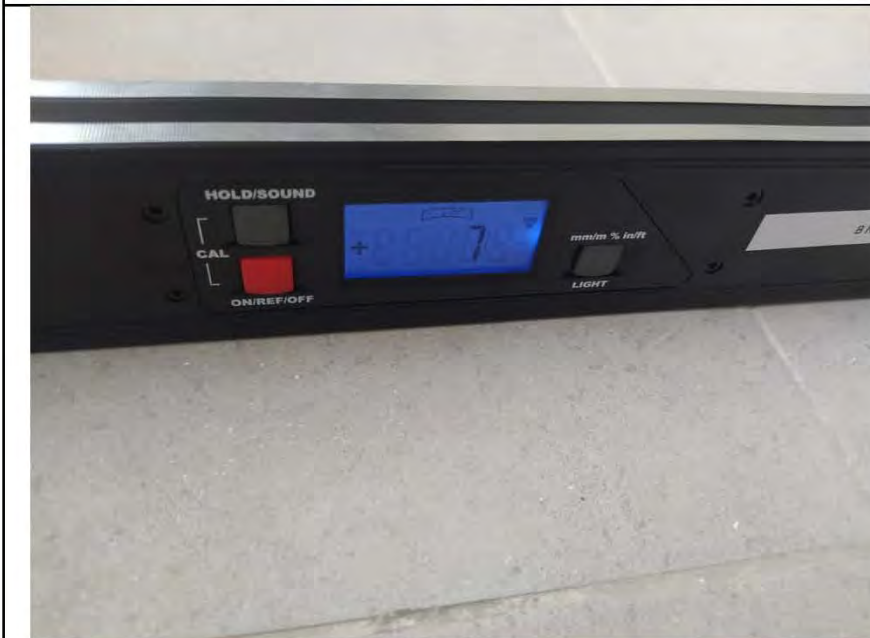
Фото №20. Измерение уровня напольного покрытия на лоджии (керамическая плитка).
