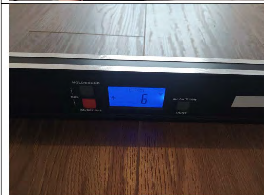
Фото №14. Измерение уровня напольного покрытия в спальне.
